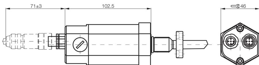
Ingombro trasduttori **TIPO TT** con connettori tipo **Y3**:
