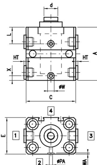
**AL** Alimentazione laterale corsa 50 mm
