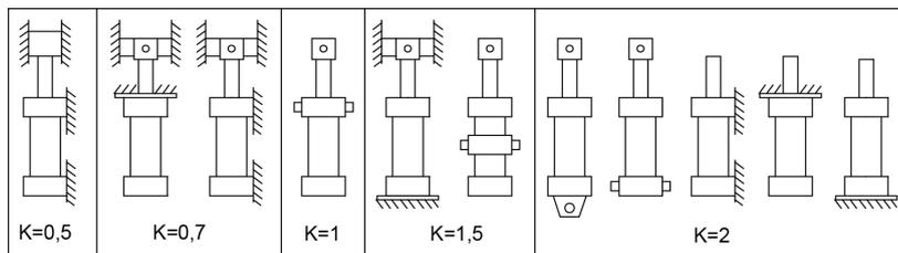
Nel **grafico 2** si verifica se il punto d'incontro tra **LV** e **F** è al di sotto della curva relativa allo stelo  $\varnothing 28$ . Non essendo verificata la condizione di stabilità bisogna adottare lo stelo differenziale  $\varnothing 45$ . Si sceglierà perciò il cilindro **CH63/45/750FA00B** per il quale la condizione di stabilità è verificata.
