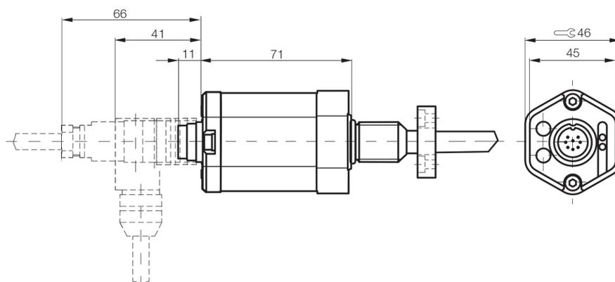
Ingombro trasduttori **TIPO HH** con connettori tipo **Y4**:
