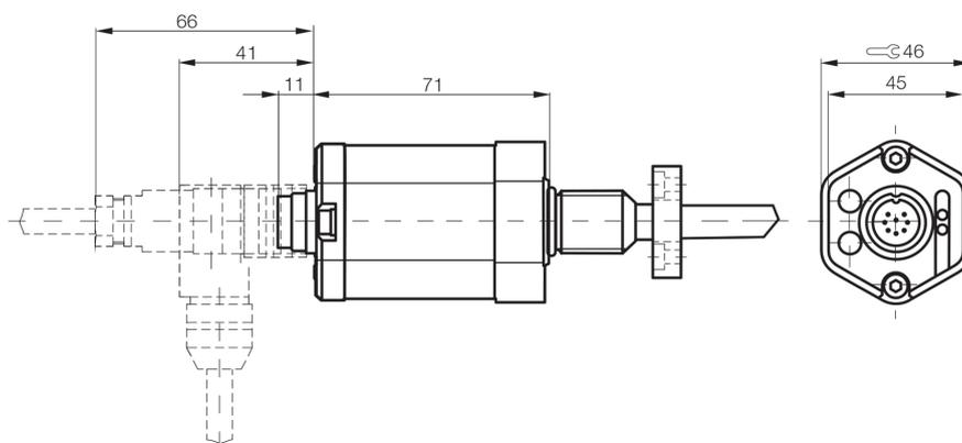
Ingombro trasduttori **TIPO HH** con connettori tipo **Y4**:
