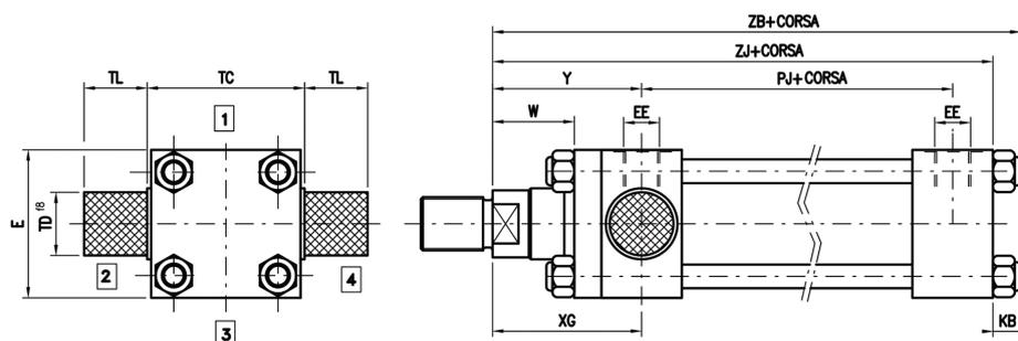
Nota: per alesaggi da 100 a 200 mm la testata e la flangetta sono in un unico pezzo e i tiranti sono avvitati direttamente nella testata
