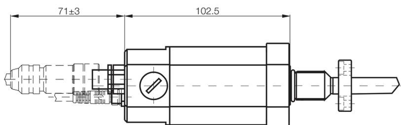
Ingombro trasduttori TIPO IO/LINK con prese tipo Y5 e Y6
