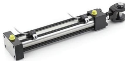
La serie di **cilindri CHM**, con i **sensori di prossimità regolabili**, deriva dalla serie CH, in conformità alle norme internazionali **ISO 6020/2 e DIN 24554**. La costruzione compatta a testate quadre con tiranti è adatta ad ogni tipo di applicazione industriale con pressione nominale continuativa fino a **12 MPa**.
