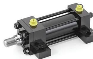
La serie di **cilindri CH** è in conformità alle norme internazionali **ISO 6020/2 e DIN 24554**. La costruzione compatta a testate quadre con **tiranti** è adatta ad ogni tipo di applicazione industriale con pressione nominale continuativa fino a 16 MPa.
