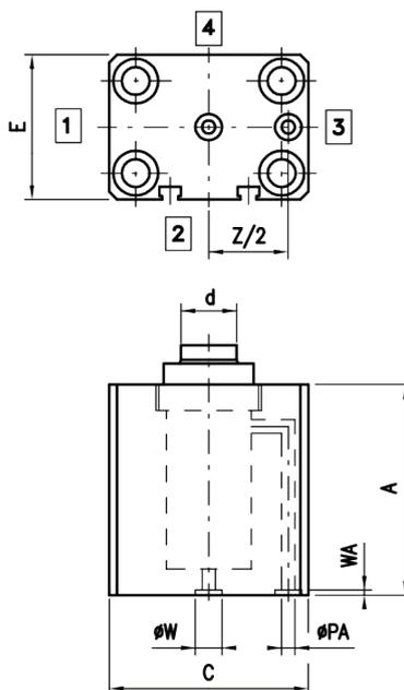
**AP** Alimentazione posteriore corsa 50 mm
