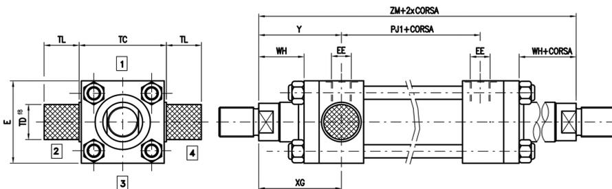
Nota: per alesaggi da 100 a 200 mm la testata e la flangetta sono in un unico pezzo e i tiranti sono avvitati direttamente nella testata
