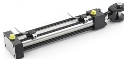
La serie di **cilindri CHM**, con i **sensori di prossimità regolabili**, deriva dalla serie CH, in conformità alle norme internazionali **ISO 6020/2 e DIN 24554**. La costruzione compatta a testate quadre con tiranti è adatta ad ogni tipo di applicazione industriale con pressione nominale continuativa fino a **12 MPa**.
